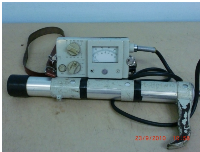
Рис7 - Прибор сцинтилляционный геологоразведочный СРП-68-01
