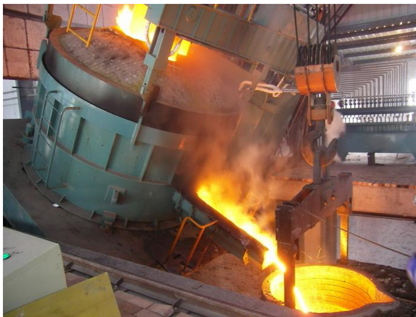
Рисунок 1.2. Слив сплава из рабочей зоны.
