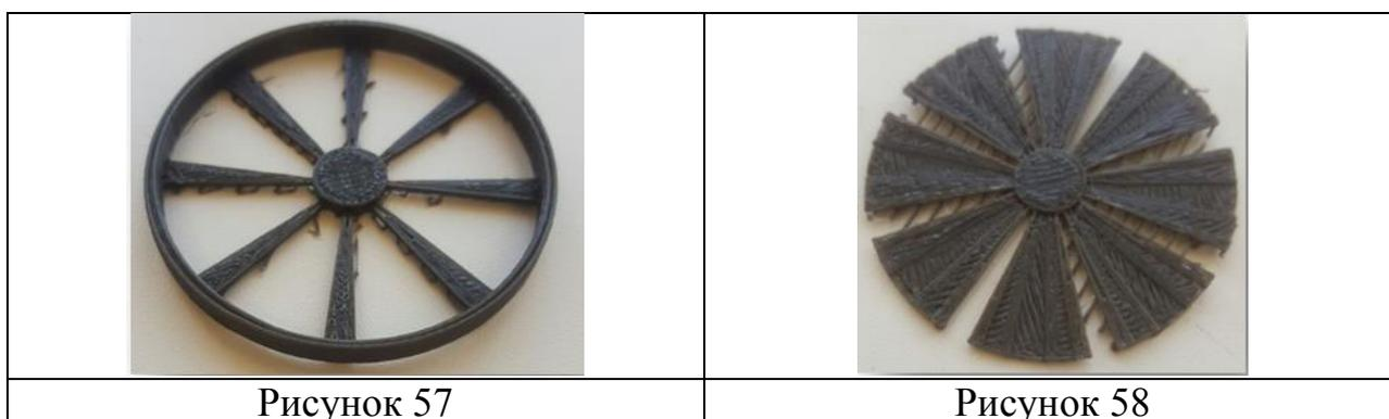
Видно, что поверхность имеет отчетливые следы нанесения пластика экструдером 3Д принтера, видно наличие основы (это элемент, который присутствует на всех заготовках свойственен при использовании данной
