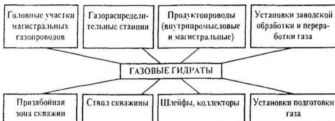
Рисунок 2.3.1 - Места образования гидратов.
