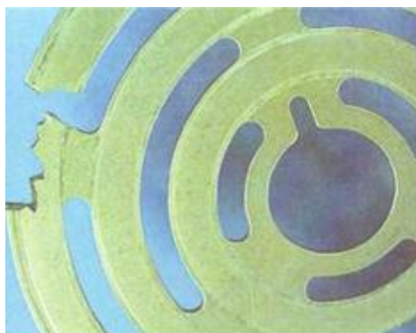
Рисунок 32- Поломка пластины по наружному диаметру
