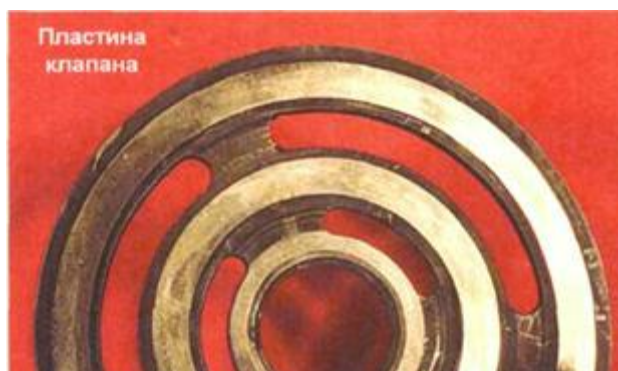
Рисунок 34- Вибрация пластины из-за высокой нагрузки от пружин
