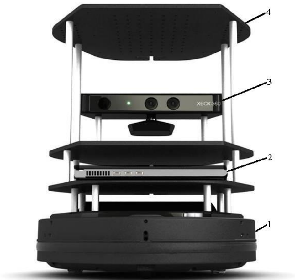
Рисунок 2.2 – Мобильный робот TurtleBot 2:
