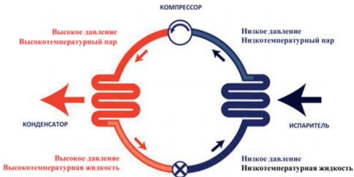
Рисунок 1- Принцип работы теплового насоса
