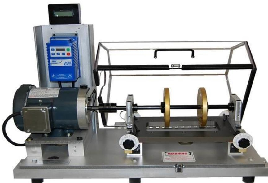
Рисунок 2. “Machinery fault simulator” компании SpectraQuest.
