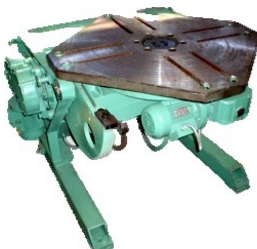
Рисунок 6 Позicionер - вращатель универсальный сварочный М11050А [17].
