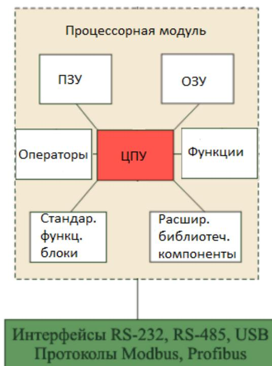
Рисунок 4.1. Типовая архитектура ПЛК
