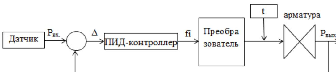
Рисунок 4.2. Принципиальная схема регулирования
