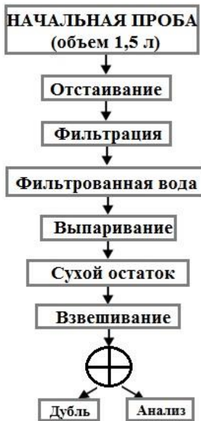
Рисунок 7 – Схема подготовки и обработки проб подземных вод [18]
