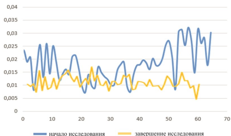
Рисунок 35. Изменение коэффициента трения во времени по закону нагружения коленчатого вала ГРМ.
