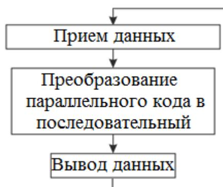
Рис. 3.12 Алгоритм работы блока связи с компьютером.
