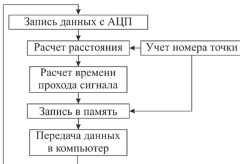
Рис. 2.5 Блок-схема расчета изображения, вариант 1.
