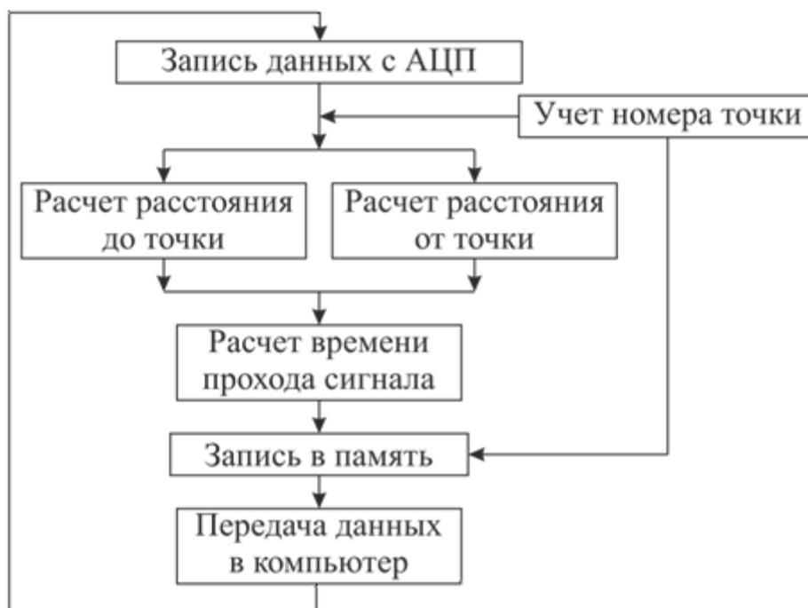
Рис. 2.6 Блок-схема расчета изображения, вариант 2.
