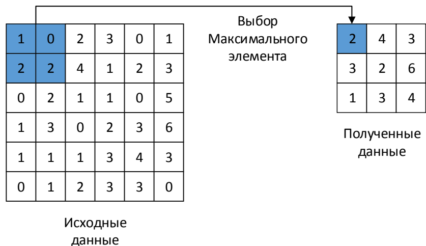
Рисунок 7 – Принцип работы нейронов подвыборочного слоя
