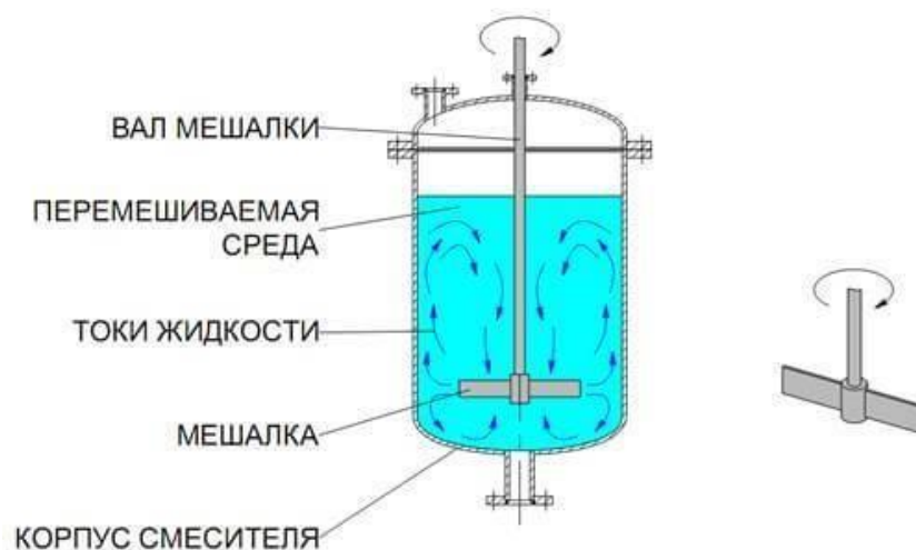
Рис. 2 Обычный сосуд с мешалкой
