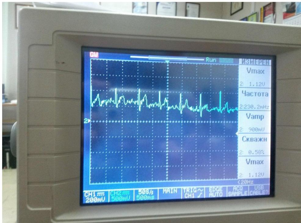
Рисунок 21- Электрокардиограмма на осциллографе
