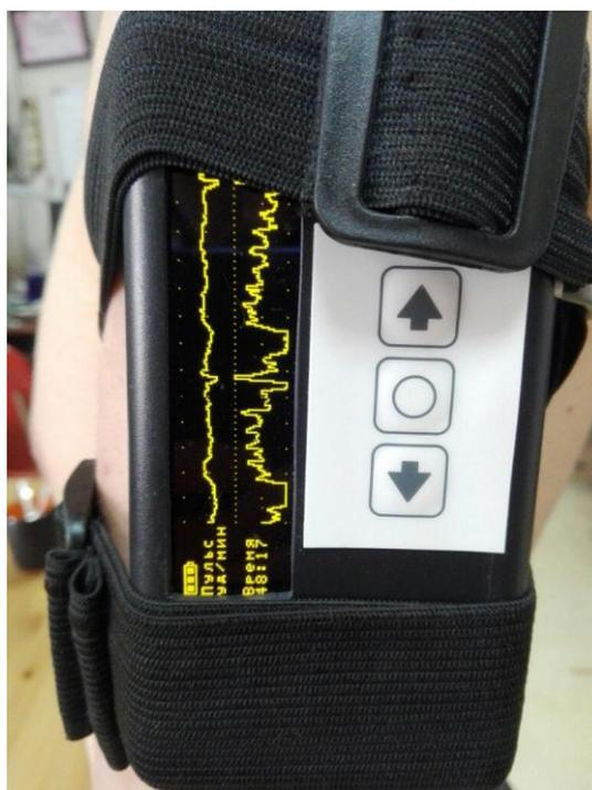
Рисунок 27- ЭКГ с плеча с помощью металлических пластин
