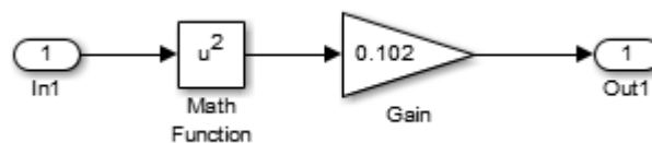
Рисунок 34 – Подсистема «Funktion» при законе регулирования U_1/f_1^2 = \text{const}
