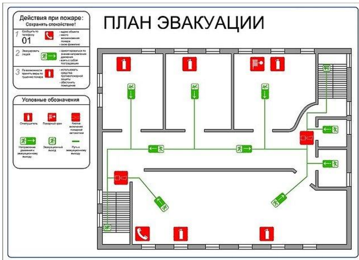
Рис. 2 План эвакуации с первого этажа производственного помещения
