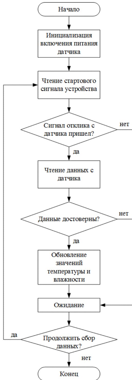
Рисунок 29 – Алгоритм считывания данных с датчика влажности DHT22
