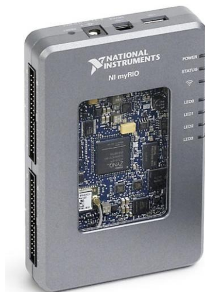
Рисунок 17 – Устройство National Instruments myRIO
