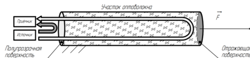
Рисунок 2.6 – Схема ВОДД на основе интерферометра Фабри-Перро
