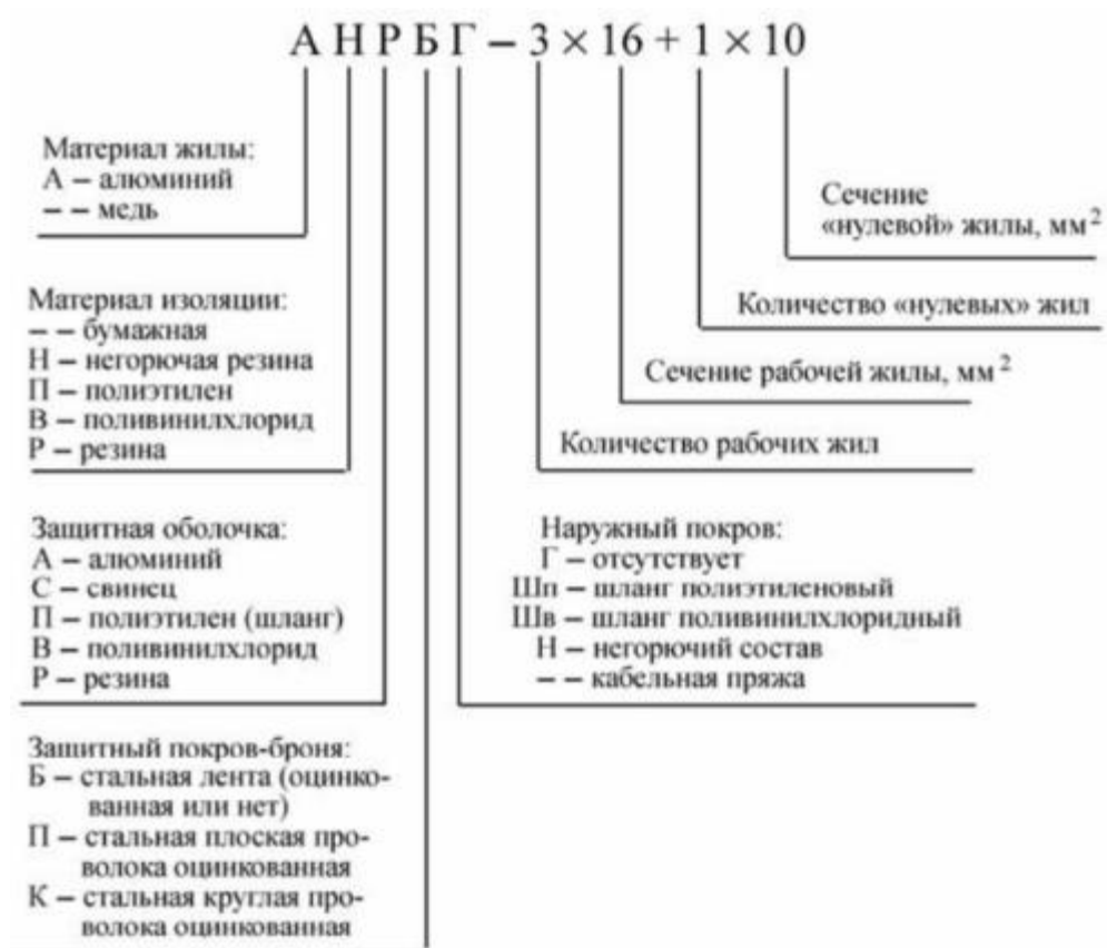
Рисунок 1 - Расшифровка маркировки кабельных изделий
