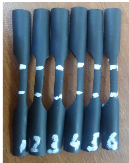
Рисунок 2.2 - Форма образцов для испытаний на растяжение
