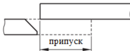
Рисунок 1.4.5 – Зубчатый монтажный стык и подготовка кромок для стенки РВС 5000 м 3
