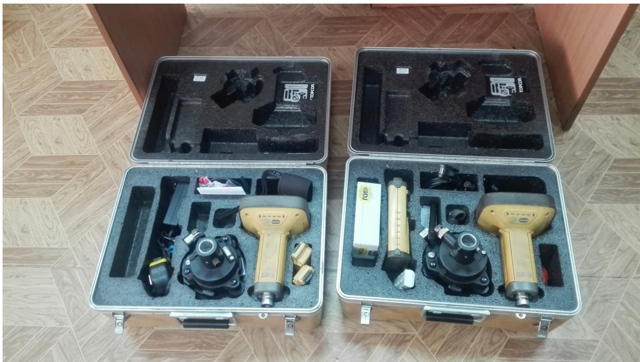
Рисунок 3.1 – Спутниковый приемник TopconGr-3 (Gps+Glonass, L1+L2) [88]
