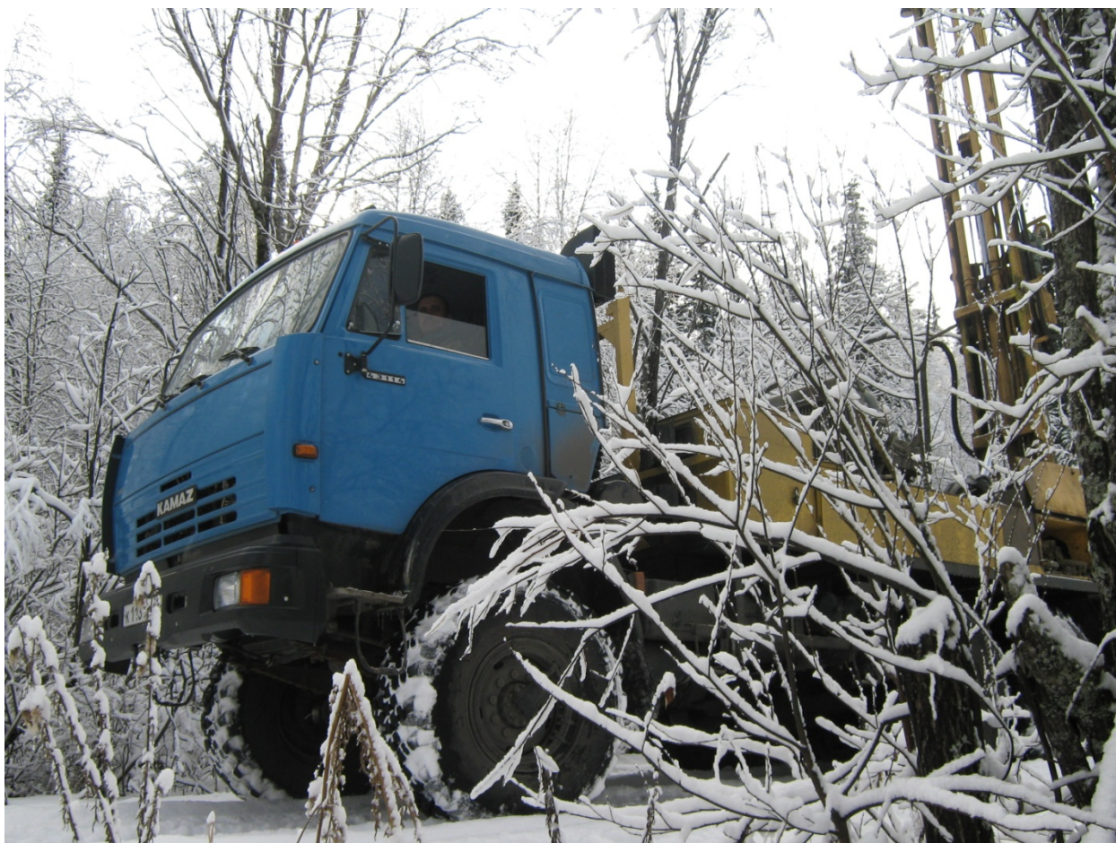
Рисунок 3.2 – Буровая установка УРБ-2А-2 на базе автомобиля Камаз 43114 [88]
