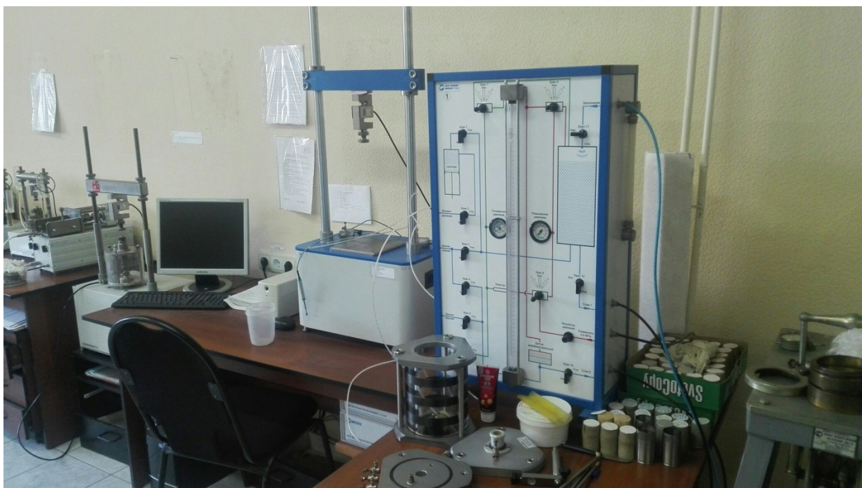
Рисунок 3.6 – Прибор (трехосное сжатие) для определения характеристик прочности и деформируемости [88]
