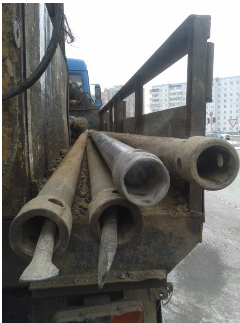
Рисунок – 3.4 Трехметровые штанги, для подъема и спуска колонковой трубы [88]
