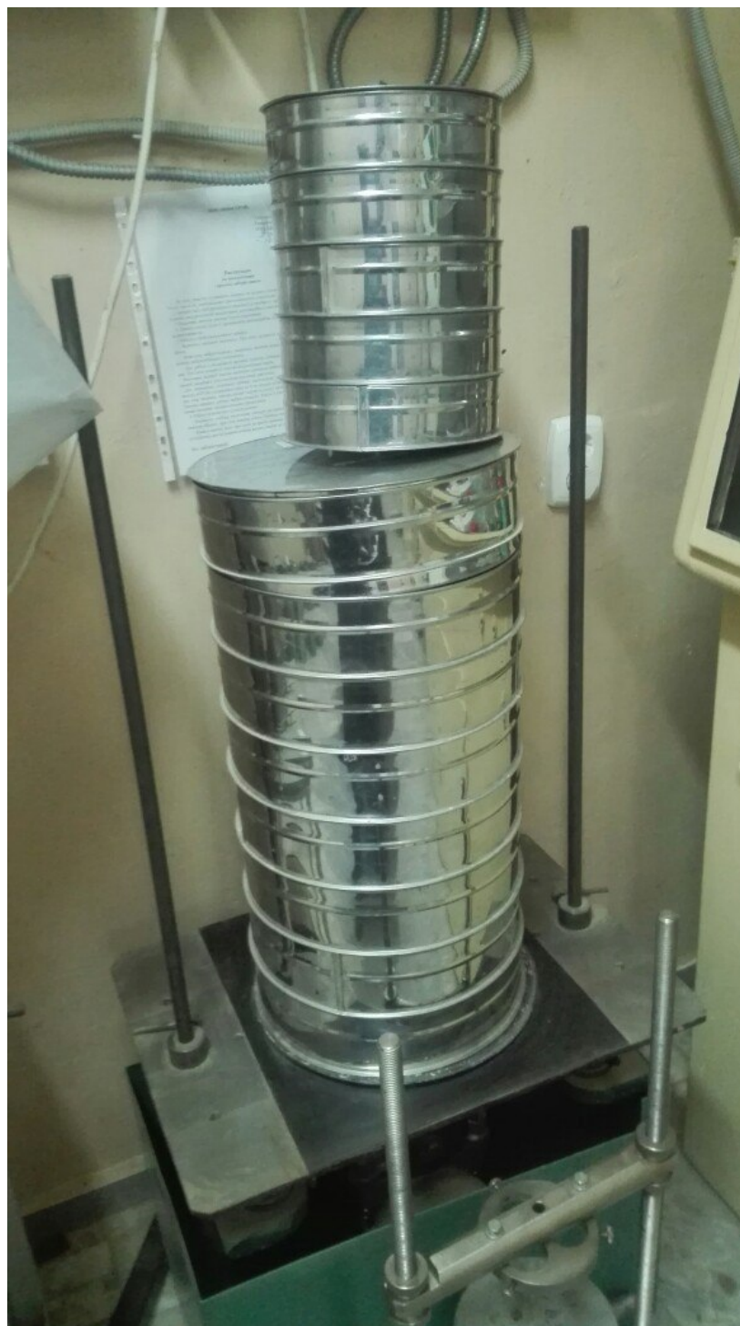
Рисунок 3.5 – Ситы для определения гранулометрического состава [88]
