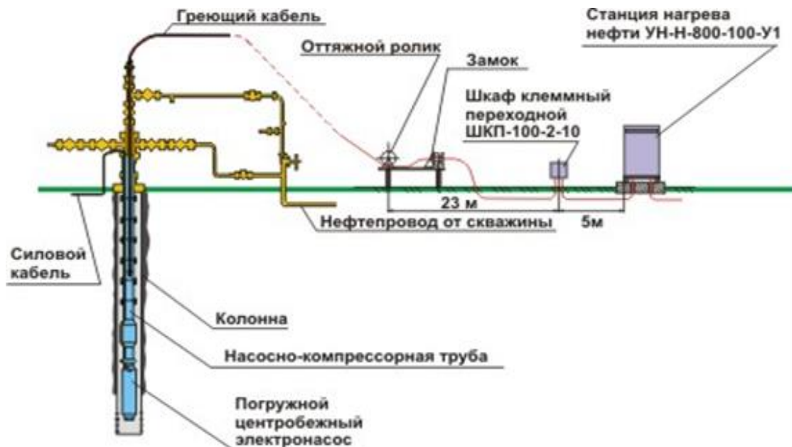
Рисунок 3.10 – Установка для спуска нагревательного кабеля и депарафинизации
