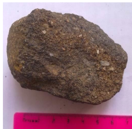
Рис.2. Обр.№1. Песчаник неравномернoзернистый
