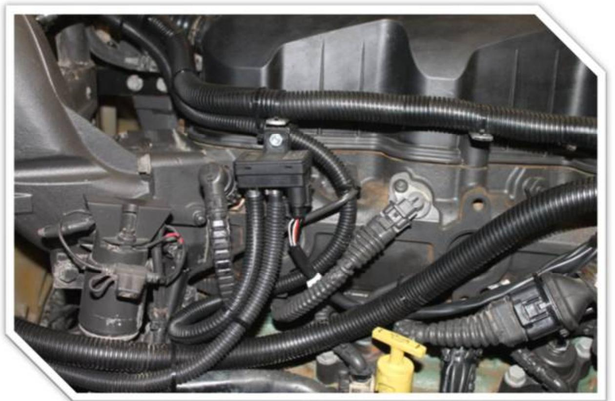
Рисунок 21 – Датчик давления и разрежения АЕВ
