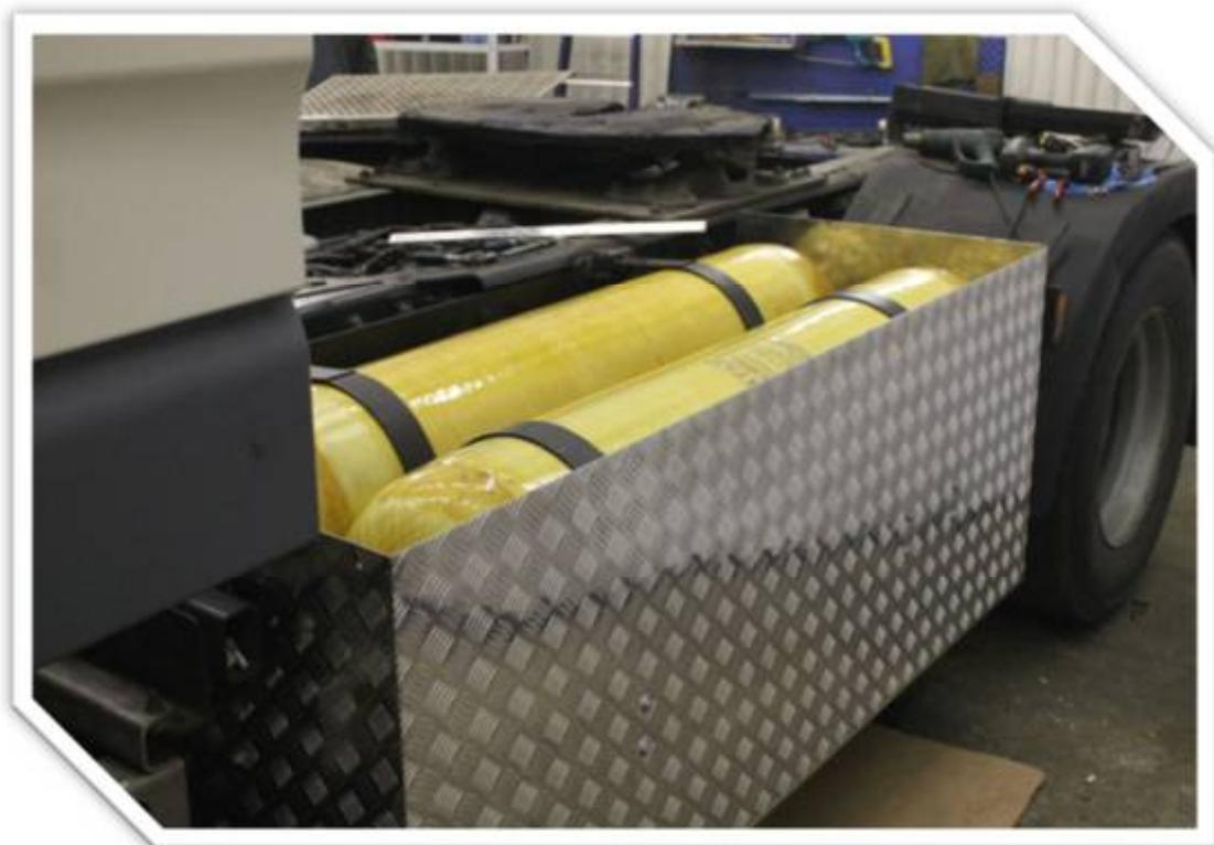
Рисунок 16 – Газовые баллоны с защитным кожухом
