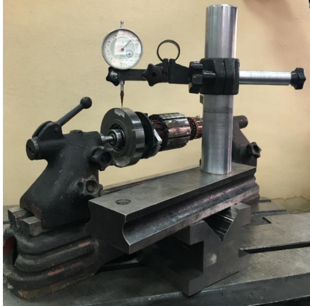
Рис.22 Установка якорь с диск генератор
