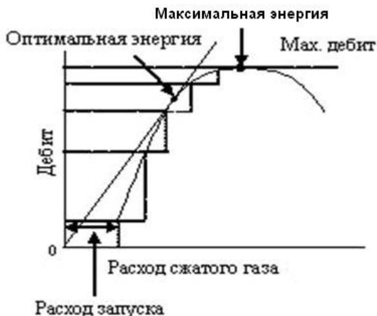
Рисунок 5.11 – Зависимость дебита от расхода сжатого газа
