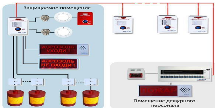
Рисунок 5 – Принцип действия установок аэрозольного пожаротушения
