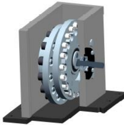
Abbildung 37 - Teilschnitt der Epizykloidengetriebe [FMDauto]
