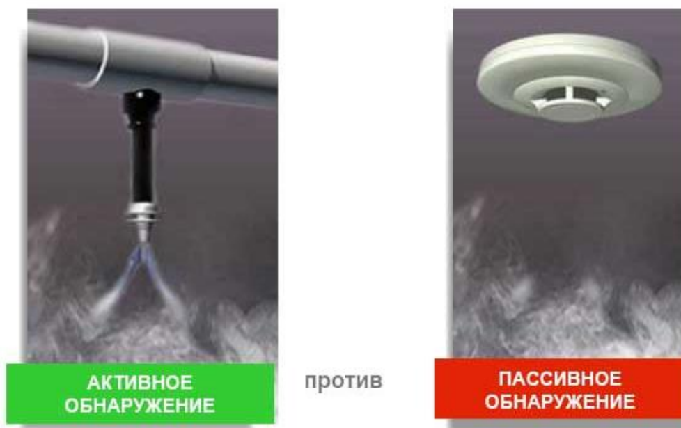
Рисунок 4.2 – Разница извещателей активного и пассивного обнаружения
