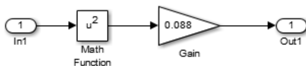
Рисунок 7 – Подсистема «Funktion» при законе регулирования U_1/f_1^2 = \text{const}
