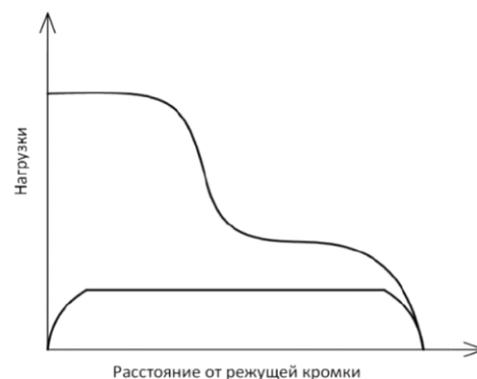
Рис.4.2. Виды распределения контактных нагрузок на рабочей поверхности. Верхний график – распределение нормального контактного напряжения, нижний - касательного
