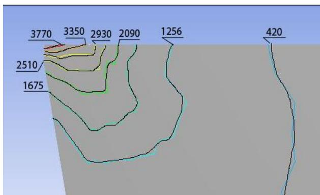
Рис. 5.2.2 а) Эквивалентные напряжения на втором резце
