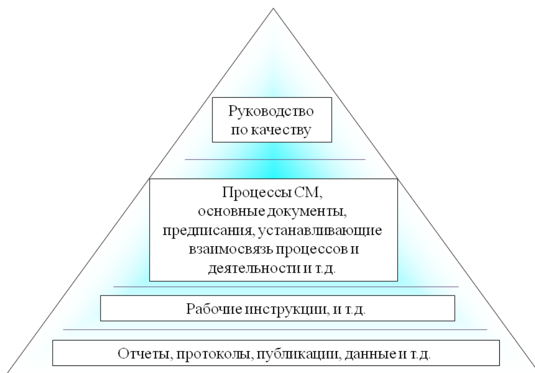
Рисунок 7 – Структура (иерархия) управляемой документации
