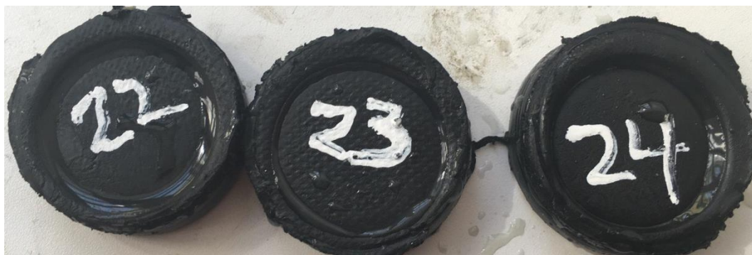
Рисунок 29 – Износ резины без смазки в полимер-глинистом растворе
