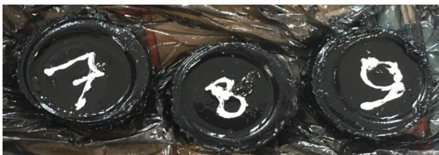
Рисунок 25 – Износ резины с тефлоновой смазкой в гидравлическом масле
