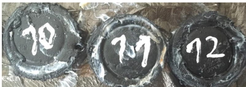
Рисунок 20 – Износ резины с эластомерной смазкой в соляном растворе
