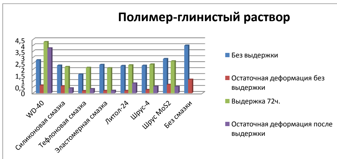
Рисунок 30- Износ резины в полимер-глинистом буровом растворе
