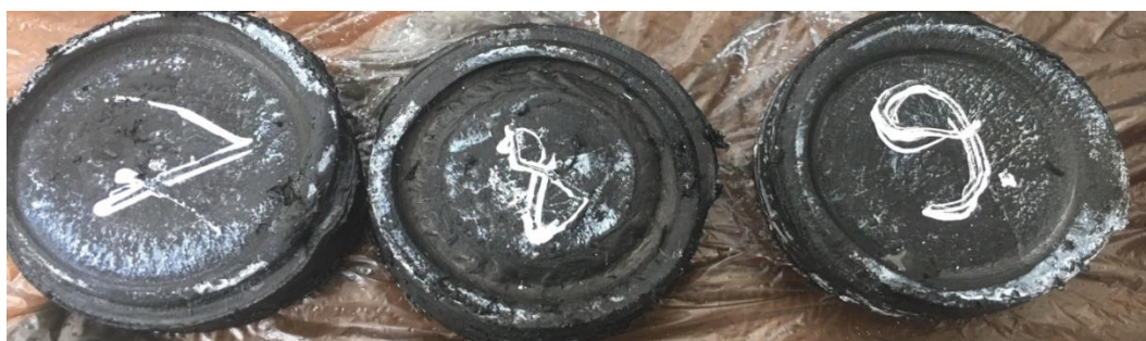
Рисунок 18 – Износ резины с тефлоновой смазкой в воде
