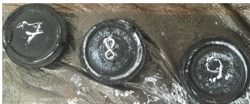
Рисунок 21 – Износ резины с тефлоновой смазкой в соляном растворе
