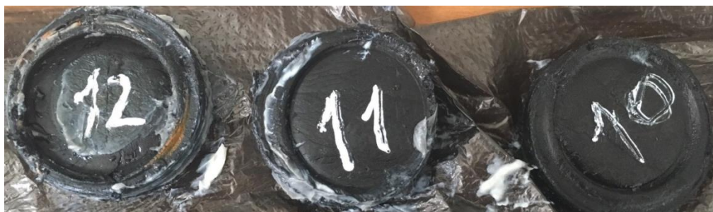
Рисунок 17 – Износ резины с эластомерной смазкой в воде
