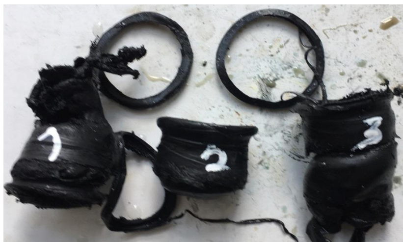
Рисунок 27 – Износ резины с WD-40 в глинистом растворе
