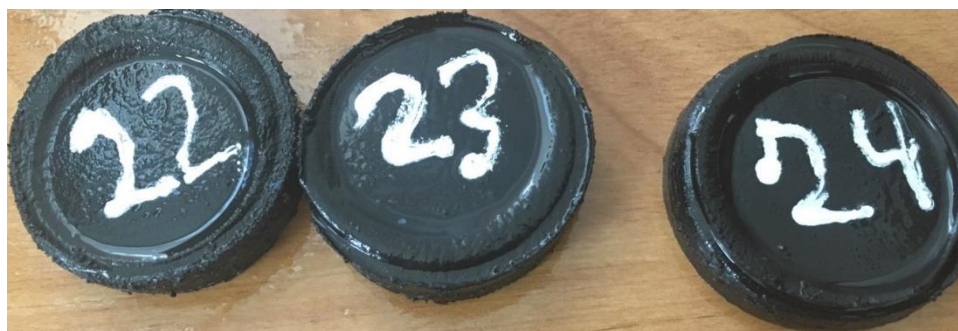
Рисунок 23 – Износ резины без смазки в дизельном топливе
