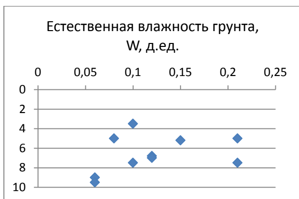
Рисунок 2.19 – График изменчивости естественной влажности элювия гранита по глубине
