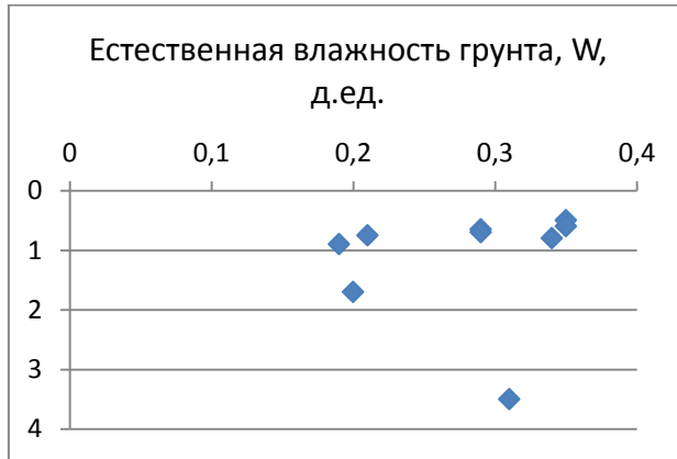
Рисунок 2.3 – График изменчивости естественной влажности суглинка по глубине
