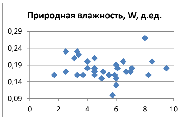
Рисунок 2.16 – График изменчивости естественной влажности песка по глубине
