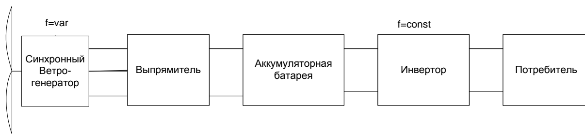
Рис.1- принципиальная схема ветроэлектростанции.
