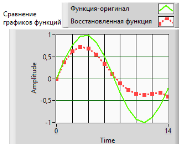
Рисунок 2.8. Сравнение графиков исходной и восстановленной синусоидальной функции
