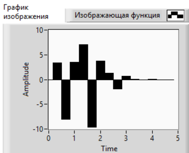
Рисунок 2.3. График изображения функции f(t) = e^{-0,5t} \cdot \sin(\omega t) при k = 15
