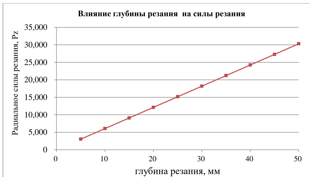
Рис. 3.3. Зависимость силы резания от глубины резания (средние значения в допустимом диапазоне)
