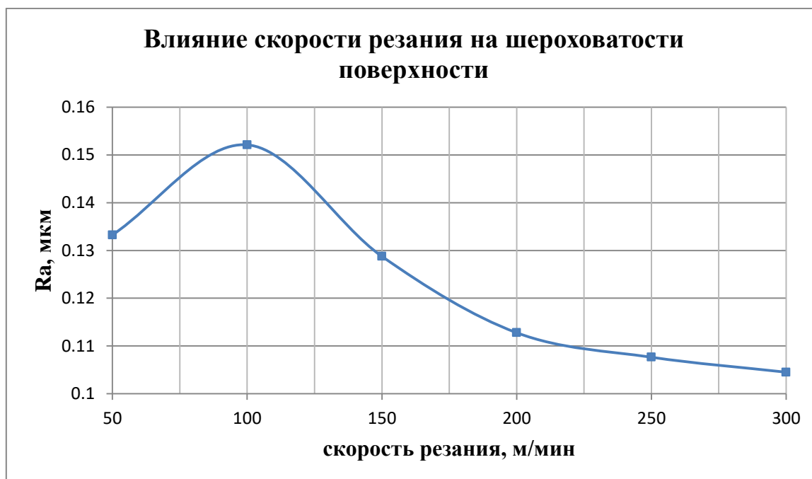
Рис 3.12. Влияние скорости резания на шероховатость
