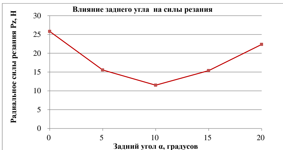
Рис. 3.6. Влияние заднего угла на силу резания
