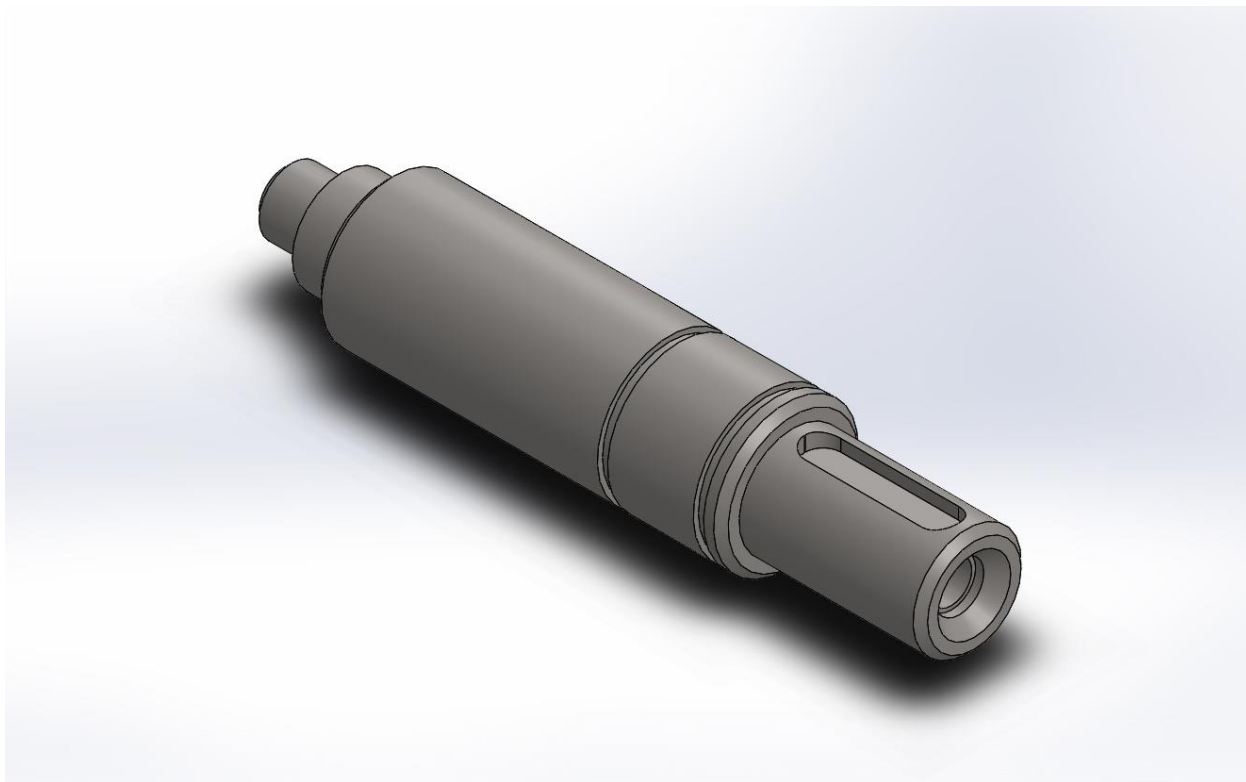
Рисунок 1 - Изображение 3D модели детали «Вал входящий»
