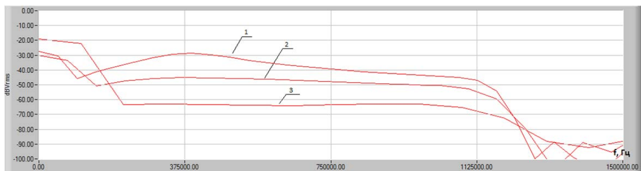
Рис. 2. Спектральная характеристика поглощения сигналов при различной температуре в жидкости (льде), где: 1 – минус 18 °С, 2 – минус 7 °С, 3 – плюс 4 °С. Ось Y – действующее значение напряжения в логарифмической шкале измерения, ось X – частота в герцах
