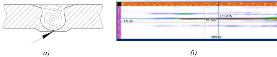
Рис. 3. Внешний вид дефекта в виде непровара с корневой стороны шва (а), С-скан образца (б)
