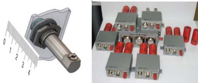
Рис. 1. Внешний вид датчика электрического поля ДЭП (слева) и аппаратуры контроля электризации (справа)
