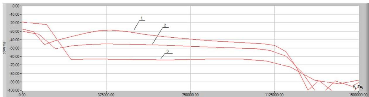
Рис. 2. Спектральная характеристика поглощения сигналов при различной температуре в жидкости (льде), где: 1 – минус 18 °С, 2 – минус 7 °С, 3 – плюс 4 °С. Ось Y – действующее значение напряжения в логарифмической шкале измерения, ось X – частота в герцах
