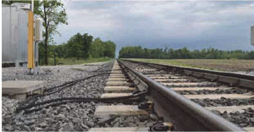
Рисунок 1.12 – Измерительный участок системы WILD [254]
