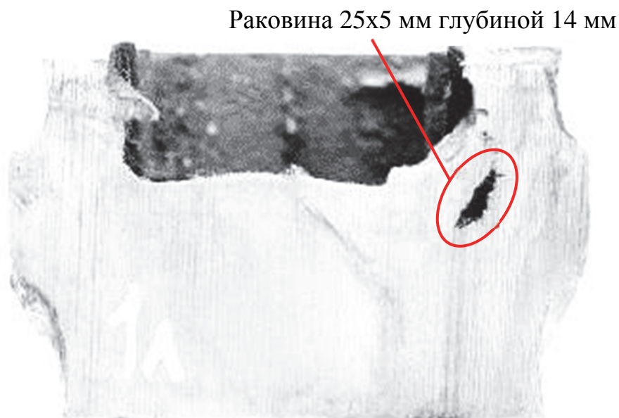
Рисунок 6.29 – Фрагмент боковой рамы с раковинной вогнутостью во внутреннем углу буксового проема
