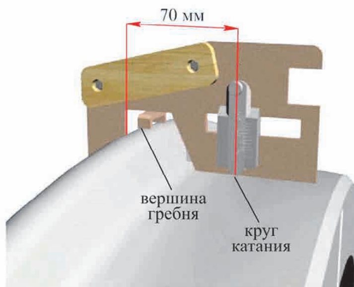
Рисунок 5.3 – Измерение проката абсолютным шаблоном
