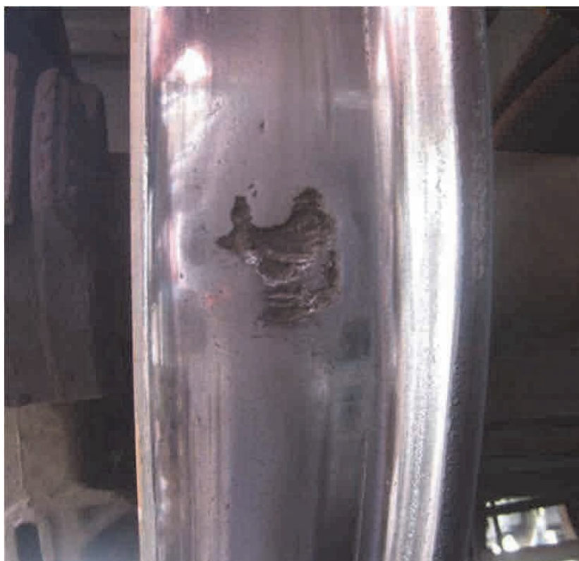
Рисунок 5.2 – Поверхность катания колеса с выщербиной
