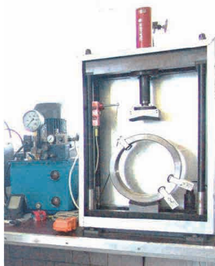
Рисунок 6.1 – Фотография нагружающего устройства контроля колец подшипников буксового узла
