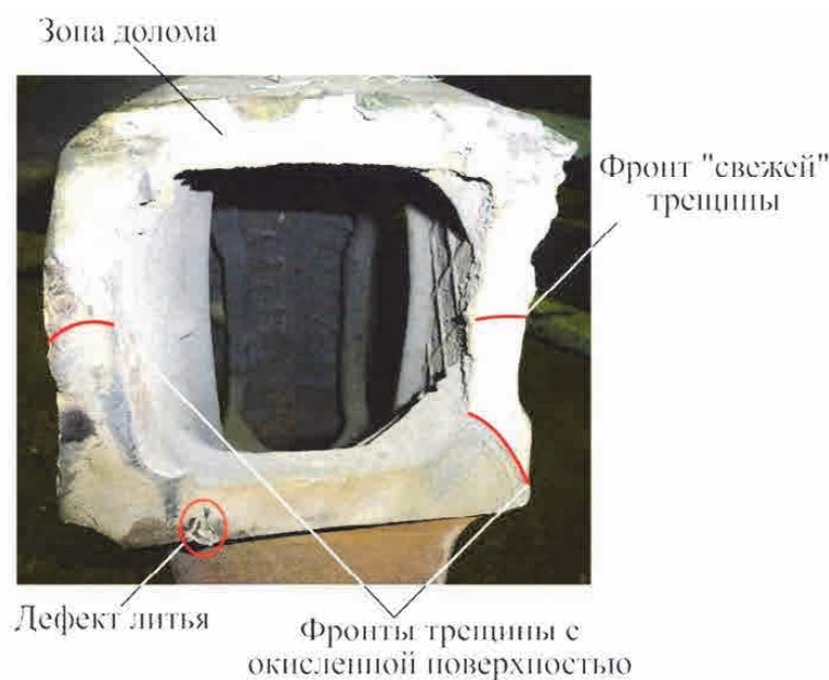
Рисунок 6.28 – Фотография излома боковой рамы по внутреннему углу буксового проема
