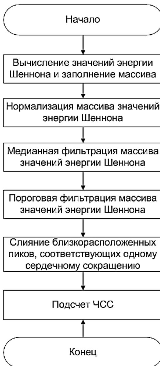
Рисунок 6 – Принципиальная схема алгоритма определения частоты сердцебиения.
