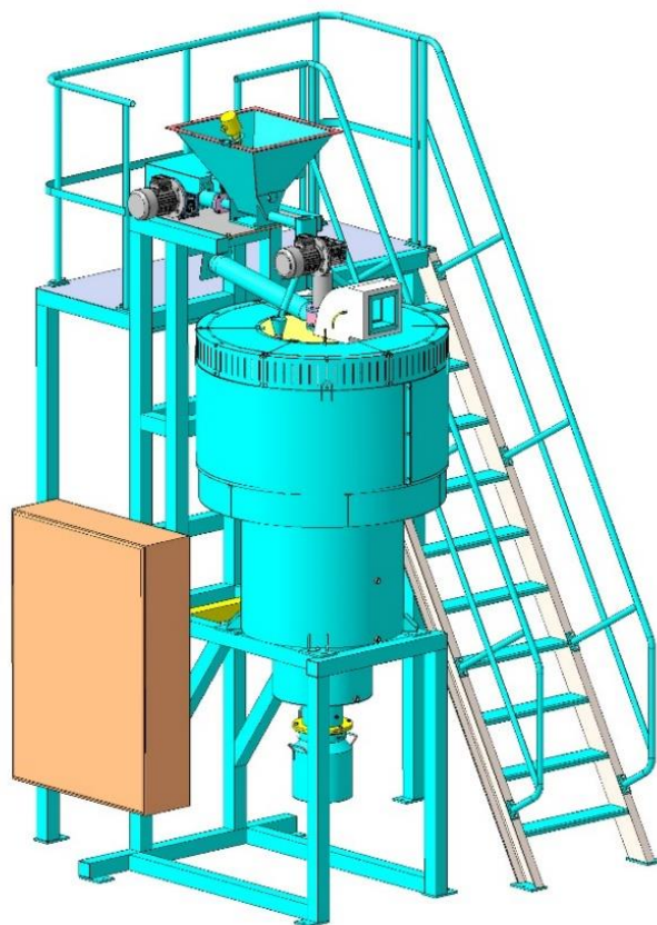
Рисунок 2 – Усовершенствованный центробежный реактор барабанного типа. Длина реактора – 2500 мм, ширина – 2400 мм, высота – 1700 мм
