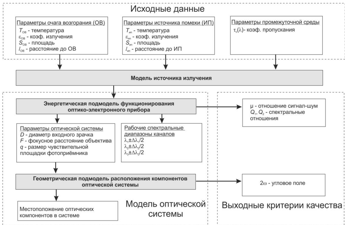
Рисунок 2 – Схема математической модели оптической системы ОЭП двух спектральных отношений
