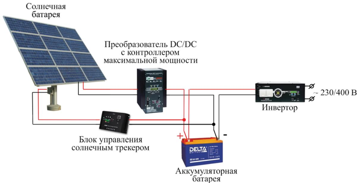
Рис. 1. Схема построения автономной фотоэлектрической станции
