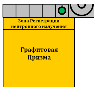
Рис. 1 – Построение нового облучательного объёма в активной зоне реактора ИРТ-Т
