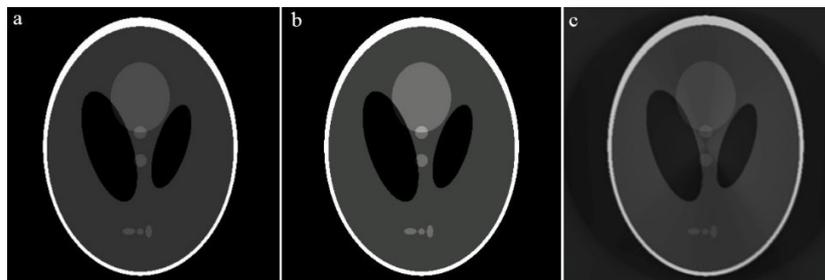
Рис. 4 – Фантомное изображение (а), изображение, восстановленное из параллельной геометрии пучка (б), изображение, восстановленное из геометрии веерного пучка (с)
