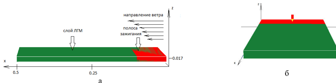
Рис. 1. Рассматриваемая модель низового лесного пожара (а – вид сбоку, б – вид спереди)
